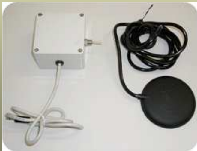
Interruttore pneumatico azionato da una cannuccia
